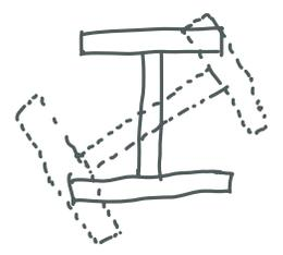
扭转变形可分成两部分 ① 绕杆轴转过一个角度 ② 沿杆轴方向翘曲。
