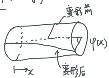
两个截面相对转动的角度 \$\varphi = \varphi(x)\$, 取一微元 \$dx\$, 得 \$d\varphi\$.
