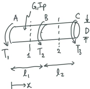
$$T_1 = -1572 \text{ N}\cdot\text{m}, \quad T_2 = 955 \text{ N}\cdot\text{m}, \quad T_3 = 637 \text{ N}\cdot\text{m}$$
