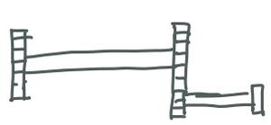
直杆端部所受载荷可以简化为作用在轴向上的力偶(扭矩)
