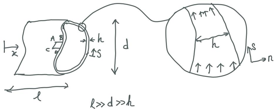
认为应力  $\tau$  沿厚度  $h$  方向的变化不重要，更关心  $\tau$  作为厚度方向的平均，对应的单位  $s$  的合力  $ch$ 。
