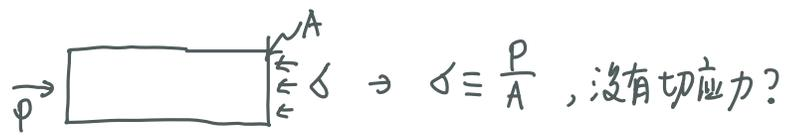
$\sigma \Rightarrow \sigma = \frac{P}{A}$ , 没有切应力?
