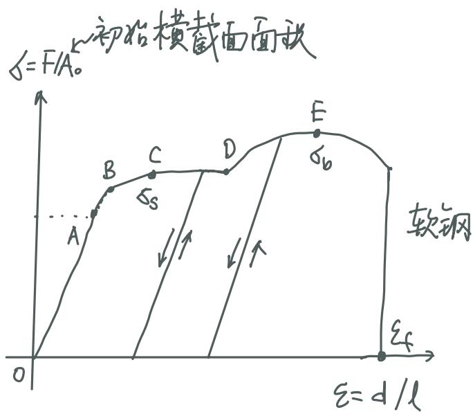
$0 \rightarrow A$ : 弹性极限  $\rightarrow B$ : 弹性极限  $\rightarrow C$ : 屈服应力  $\rightarrow E$ : 强度极限
