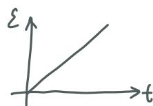
\* 弹簧与粘滞串联 (Maxwell 模型)
